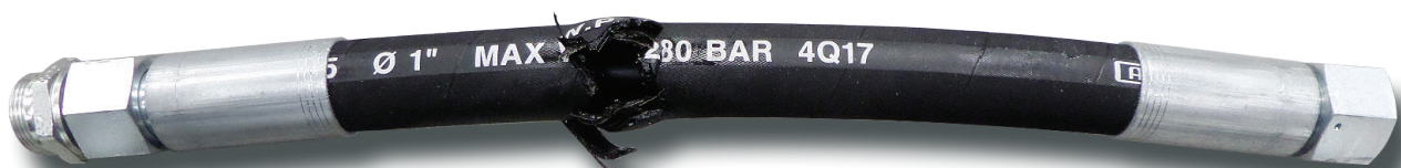
Prova distruttiva con tubo in gomma spiralato 4SP DN25, a norma EN 856. Il tubo è scoppiato a 1480 bar, senza registrare perdite o trasudamenti nei punti di tenuta.
