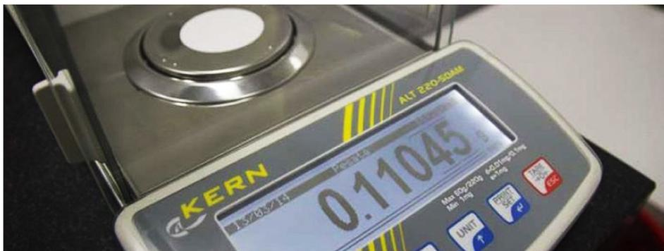
*Balance de contrôle gravimétrique*
