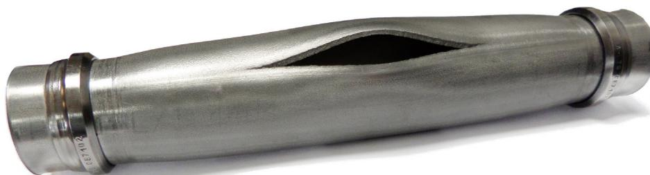
Essai destructif avec tube en acier inoxydable 316Ti, 038 x 4 mm conforme à la norme UNI EN 10216-5. Le tube a éclaté à 1270 bar sans enregistrer de fuite ou de suintement au niveau des points d'étanchéité.
