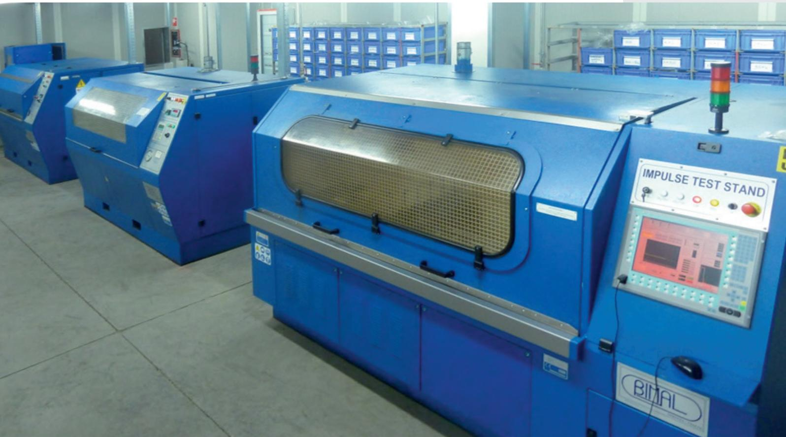
Pour garantir le haut niveau de fiabilité de ses produits, CAST S.p.A est en mesure d'effectuer, dans son propre laboratoire, des essais dynamiques sous haute pression (jusqu'à 1000 bar), ainsi que des essais statiques et d'éclatement sous très haute pression (jusqu'à 4000 bar).
