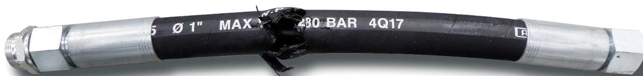
Essai destructif avec un tuyau en caoutchouc spiralé 4SP DN25, conforme à la norme EN 856. Le tuyau a éclaté à 1480 bar sans provoquer de fuite ou de suintement au niveau des points d'étanchéité.
